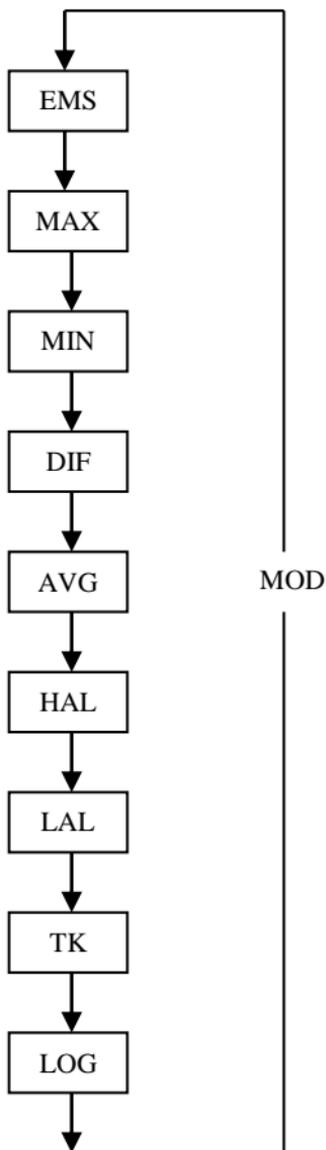
Das Infrarottemperaturmessgerät misst die Maximaltemperatur (MAX), Mindesttemperatur (MIN), die Temperaturdifferenz (DIF) und die durchschnittliche Temperatur (AVG). Jedes Mal nach dem Ablesen können die Daten gespeichert werden, und danach über die Taste MODUS (MODE) aufgerufen werden, bevor eine Messung durchgeführt wird. Wenn der Hebel ein weiteres Mal gezogen wird, wird das Gerät Messungen im zuletzt gewählten Modus durchführen.
